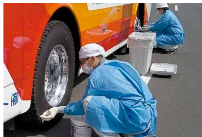
車両表面の汚染箇所を拭き取り除染する様子
