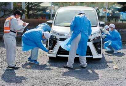
放射線測定器により、車両表面に放射性物質による汚染がないかを検査する様子
